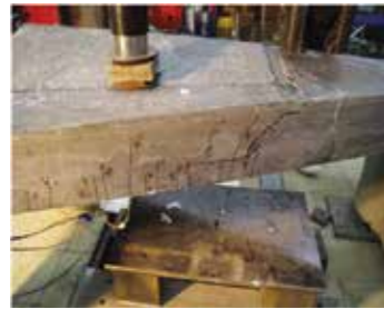
Распределение трещин в ребре образца
