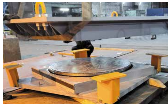
Сборка опорной части на нагрузку 8000 т для Технопарка Сколково
